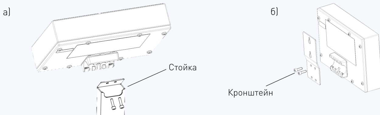
Рис. 5.2. - Варианты крепления устройства управления
